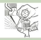
Una vez conocida la presión y caudal disponible en la red podremos elegir las boquillas para los aspersores. De esta manera podremos calcular mediante una simulación (WinSpace) los litros/m2 que obtendremos de la precipitación solapada de los aspersores.
